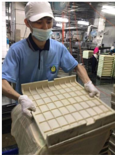
▲包布成型：手工包布時溫度高達 65°C
