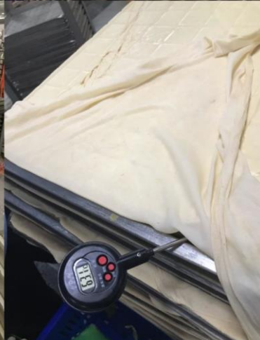
▲人工豆腐翻模：每 1 人每天需翻 500 板豆腐，鐵模加豆腐重達 12 公斤，且人工翻鐵模溫度高達 63.1°C
