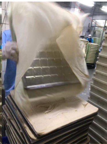
▲手工搬運模板進行壓模：溫度高達 70.1°C
