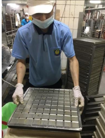
▲人工豆腐翻模：每 1 人每天需翻 500 板豆腐，鐵模加豆腐重達 12 公斤，且人工翻鐵模溫度高達 63.1°C
