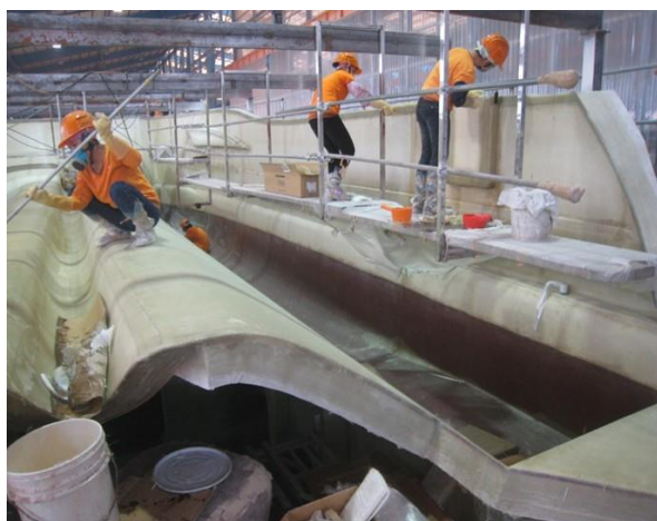
手積層作業，工作環境暴露在玻璃纖維粉塵及樹脂苯乙烯揮發
