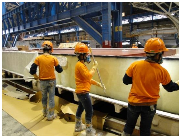
手積層作業，為避免吸入苯乙烯揮發，人員須佩戴防毒面具作業。
