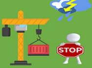
設置於室外之伸臂起重機，因強風來襲而有起重機伸臂受損之虞者，應採取必要防範措施；因強風、大雨、大雪等惡劣氣候，致作業有危險之虞時，應禁止工作。
